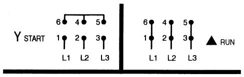
SINGLE VOLTAGE MOTOR: START ON Y, RUN ON ▲. ALSO SUITABLE FOR FULL VOLTAGE ACROSS THE LINE START ON A CONNECTION.
