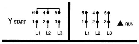
SINGLE VOLTAGE MOTOR: START ON Y, RUN ON ▲. ALSO SUITABLE FOR FULL VOLTAGE ACROSS THE LINE START ON ▲ CONNECTION.
