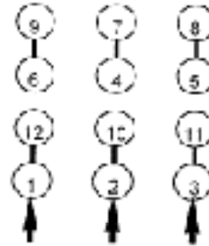
LINE 460 VOLT CONNECTION
